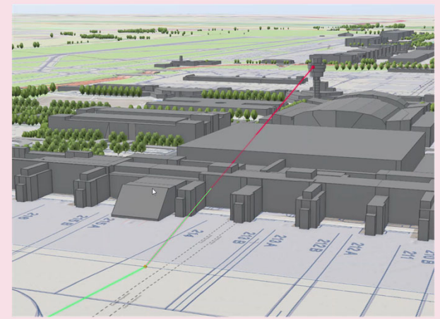
Flugbetriebsflächen müssen von den Lotsen einsehbar sein.
