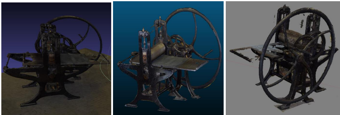
Abb. 64 3D-Modelle erfasst mit ContextCapture (links), ReCap Pro Photo (mitte) und PhotoScan Professional (rechts)
