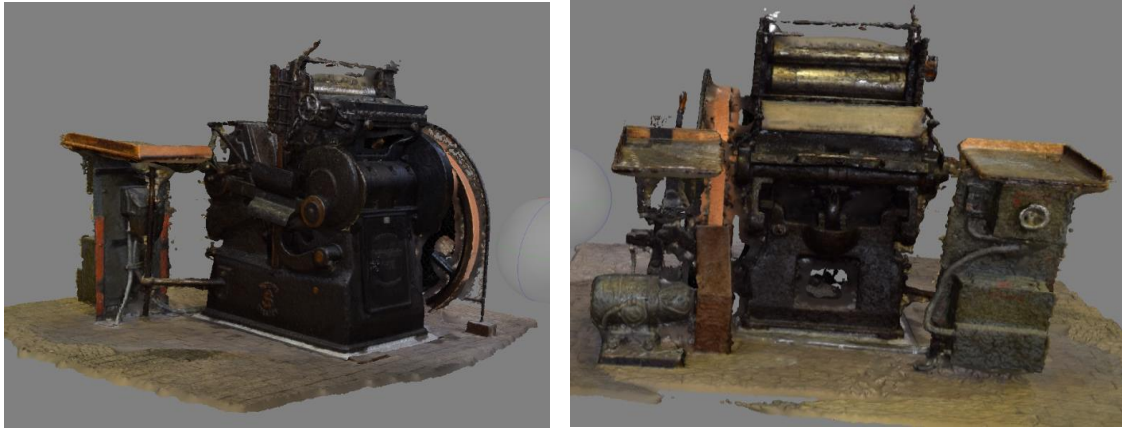
Abb.44 3D-Modelle gewonnen aus 60 Fotos mit Agisoft PhotoScan Professional
