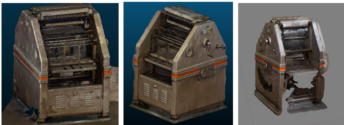
Abb. 66 3D-Modelle erfasst mit ContextCapture (links), ReCap Pro Photo (mitte) und PhotoScan Professional (rechts)
