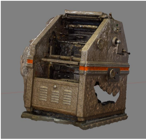
Abb.41 3-D Punktwolke (a) und 3D-Modell(b) gewonnen aus 61 Fotos mit Agisoft PhotoScan Professional
