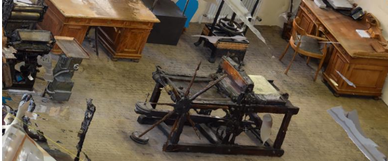
Abb. 23 3D-Modell berechnet mit ContextCapture aus 373 Fotos mit PP
