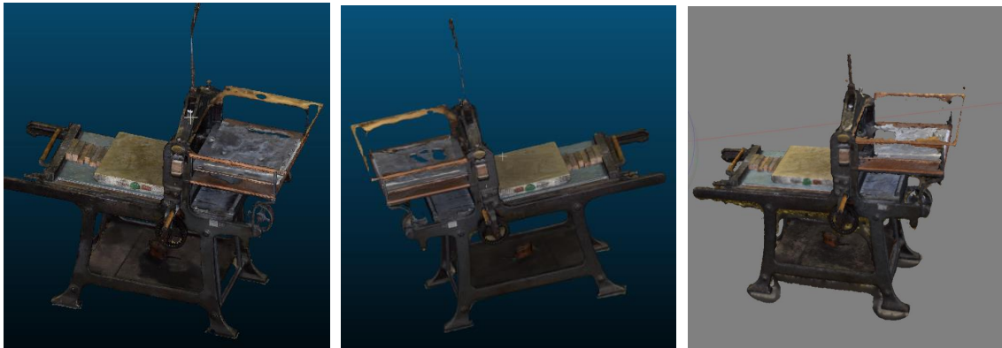
Abb.63 3D-Modelle erfasst mit ContextCapture (links), ReCap Pro Photo (mitte) und PhotoScan Professional (rechts)
