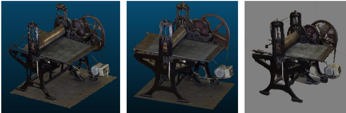
Abb. 65 3D-Modelle erfasst mit ContextCapture (links), ReCap Pro Photo (mitte) und PhotoScan Professional (rechts)
