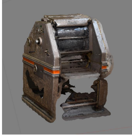
Abb.41 3-D Punktwolke (a) und 3D-Modell(b) gewonnen aus 61 Fotos mit Agisoft PhotoScan Professional
