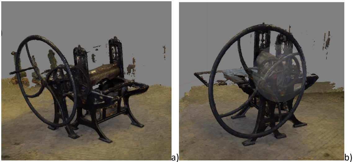
Abb.37 3-D Punktwolke (a) und 3D-Modell(b) gewonnen aus 84 Fotos mit Agisoft PhotoScan Professional
