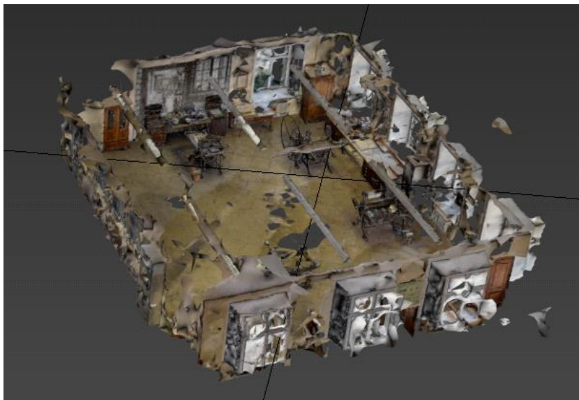
Abb. 20. 3D-Modell berechnet mit ContextCapture aus 177 Bildern
