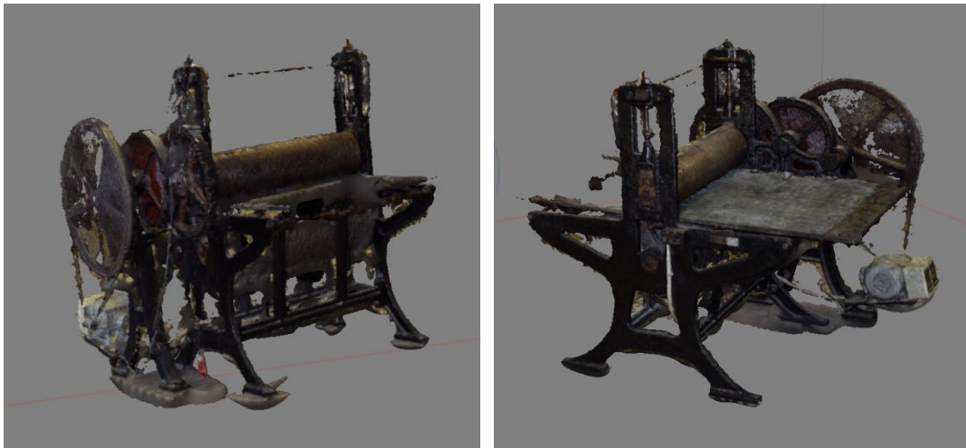
Abb.39 3D-Modelle gewonnen aus 57 Fotos mit Agisoft PhotoScan Professional
