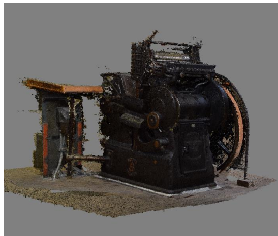
Abb.43 3-D Punktwolke gewonnen aus 60 Fotos mit Agisoft PhotoScan Professional
