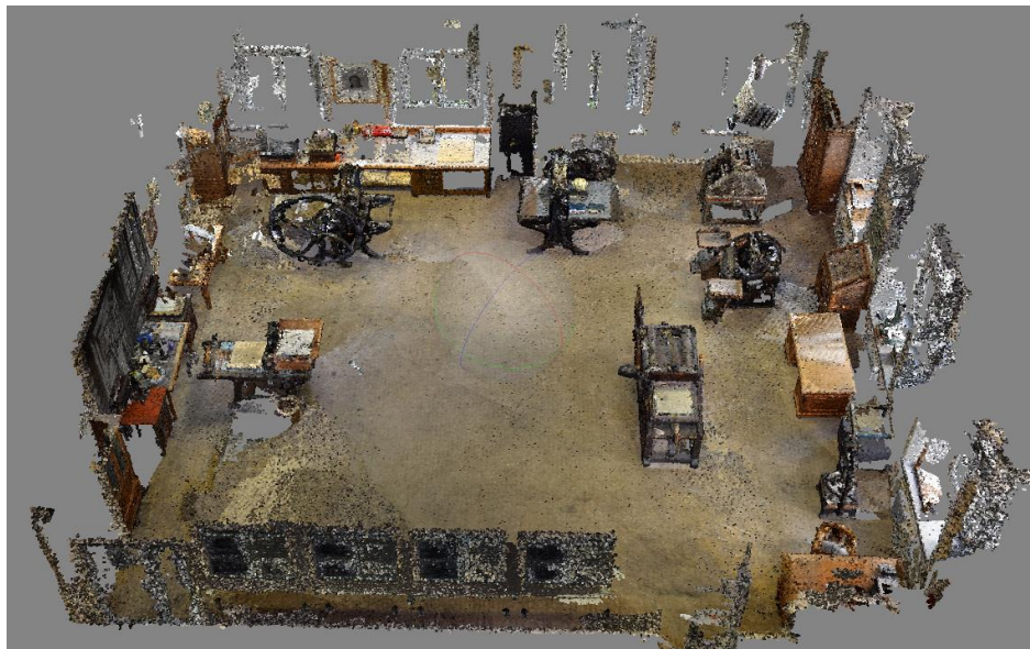
Abb. 26 a) &b) Dichte 3D-Punktwolke berechnet mit Agisoft PhotoScan Professional aus 834 Bildern
